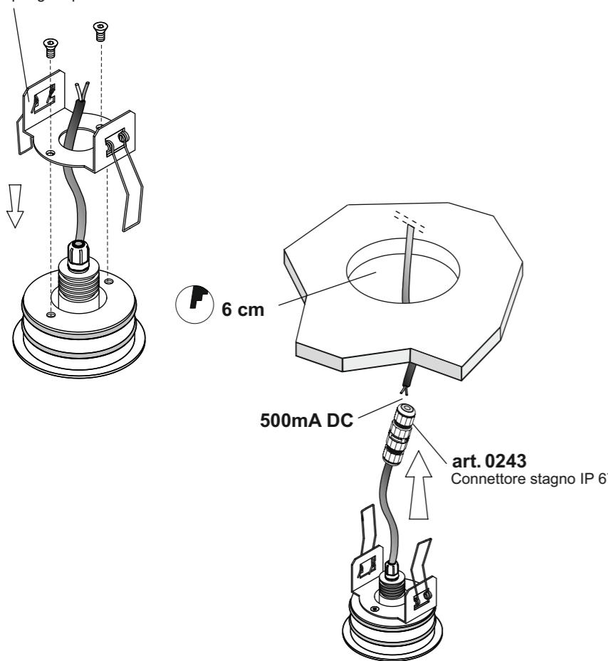
Collegamento in serie - Series connection - Connection en série
